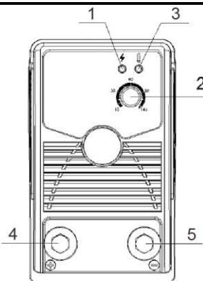
1. Сигнальная лампа 1 (загорается при включении аппарата в сеть)
